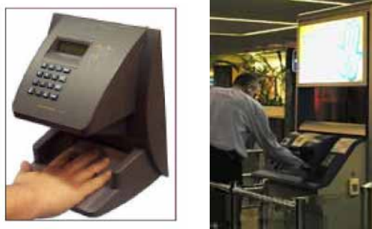
Figura 1.12. Sisteme de verificare folosind geometria mâinii, la Aeroportul Internațional „Ben Gurion” din Tel Aviv
