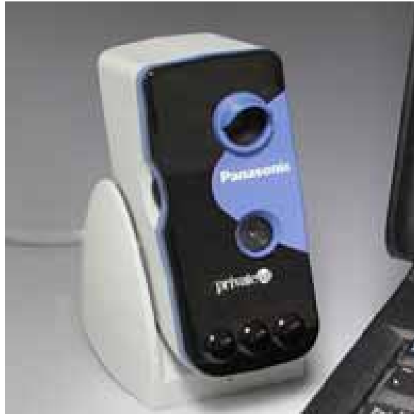
Figura 3.2. Camera cu obiectiv pentru recunoaștere după iris (sus) și webcam (jos) Panasonic BM-ET100US
