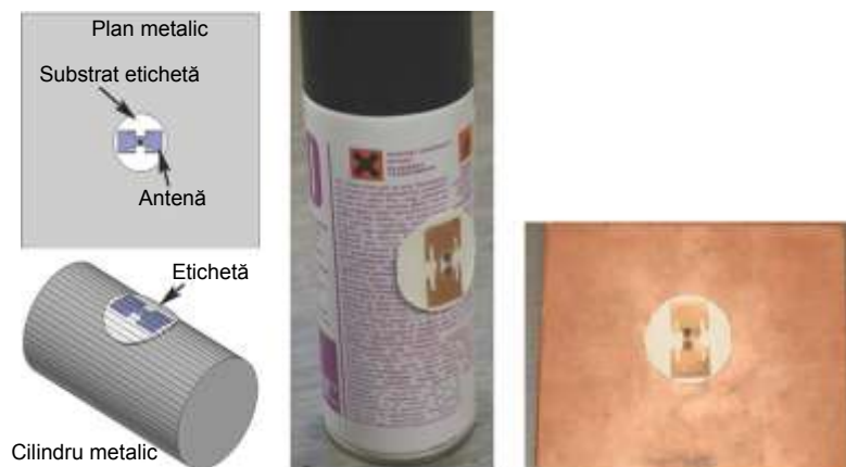
Figura 2.18 Antenă RFID flexibilă cu substrat din material ceramic [35]
